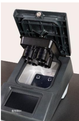
图 1.21 打开 Tecta B4 维修盖
