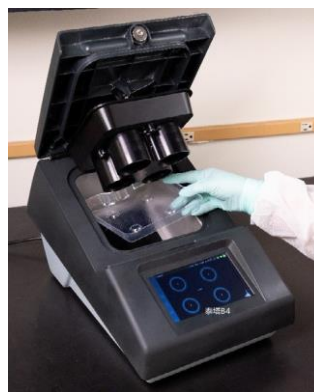
图 1.22 拆卸 Tecta B4 光学盖
