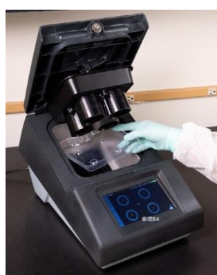
图 1.22 拆卸 Tecta B4 光学盖
